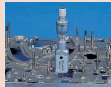
Using the optional extension rod
